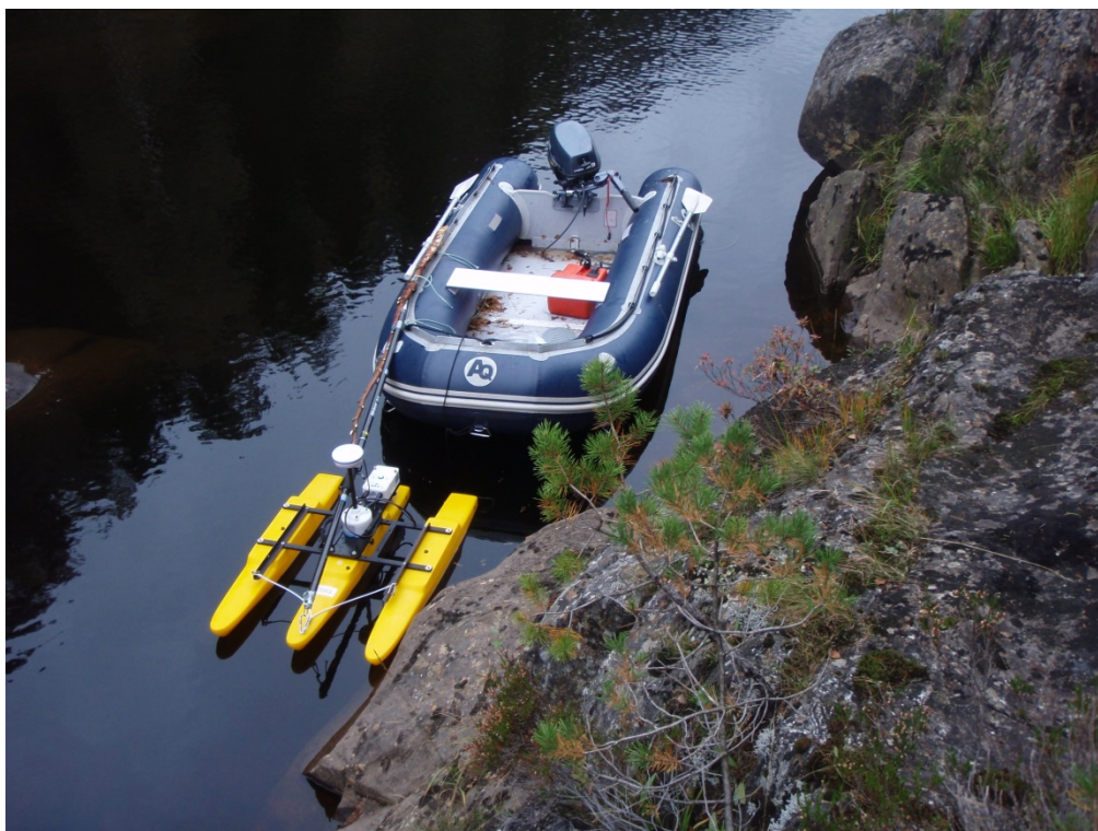
Figur 4. Innsamling av data for posisjon, vannhastigheter og vanndyp med instrumentet Sontek M9 montert foran båt.
